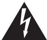
Le symbole de l'éclair avec une pointe de flèche à l'intérieur d'un triangle équilatéral met en garde l'utilisateur contre la présence de tension dangereuse, non isolée, à l'intérieur de l'appareil, dont l'amplitude peut être suffisante pour induire un risque d'électrocution d'une personne.
